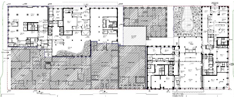
Proposed Ground Floor Plan of Block 2, with out-of-scope portions hatched in diagonally Plan proposé pour le rez-de-chaussée de l'ilot 2, les parties hors champ étant hachées en diagonale.
